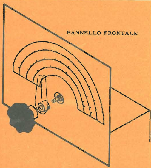
Fig. 17 - Montaggio dell'indice e della manopola sulla scala graduata.
