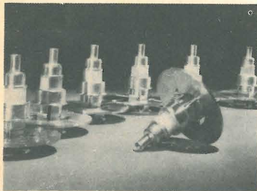
MICROONDE - Recentemente sono stati prodotti nuovi tubi a dischi (Lighthouse) da impiegare nelle apparecchiature elettroniche dei satelliti artificiali. Da notare il maggiore diametro del disco di griglia che funziona da radiatore per il raffreddamento del tubo. Questi tubi funzionano alla frequenza di 2,9 GHz per un tempo di 25.000 ore.
